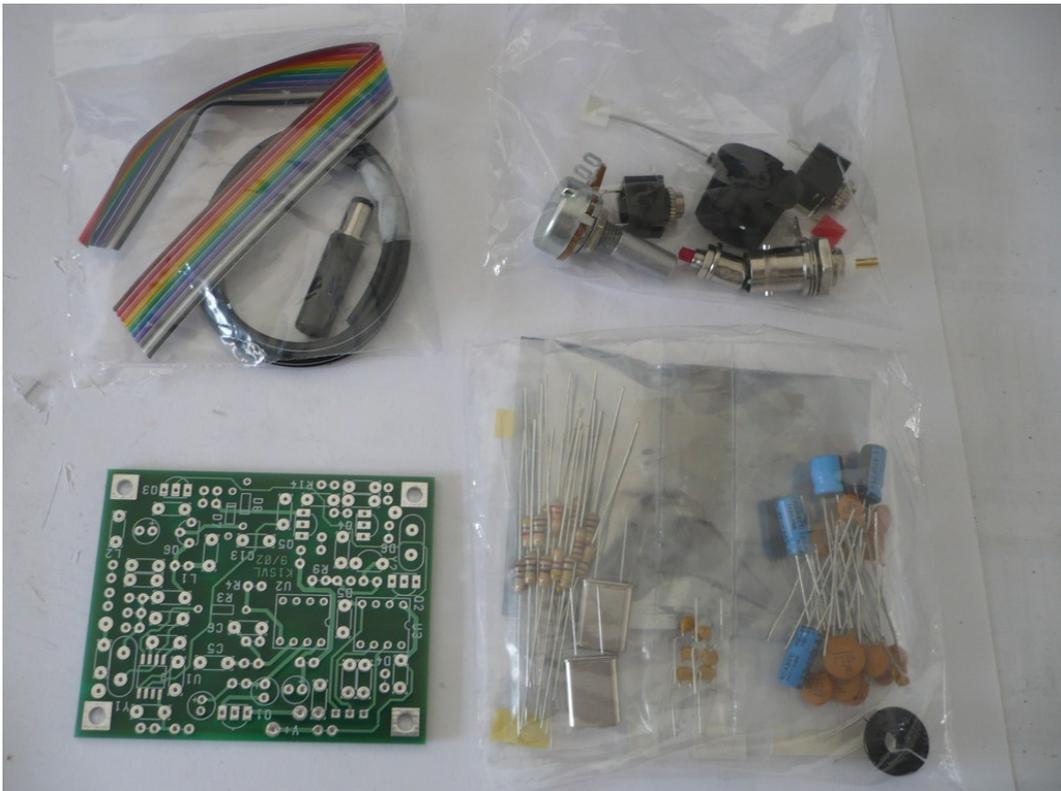
Je conseille d'écrire les références des composants sur les bandes de maintien des diodes, des transistors et autres. Cela permet de les repérer plus facilement lors du montage.
